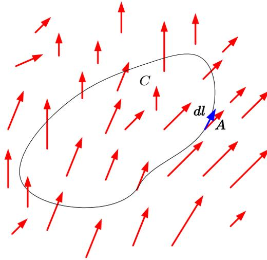
図 10: 流体の速度場と回転を計算する経路
