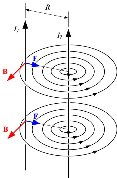
図 1: 2本の平行導線に働くアンペールの力
