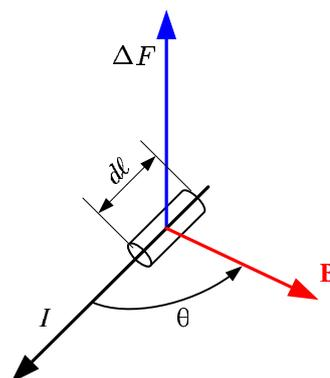
図 2: 電流要素に働くアンペールの力
