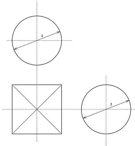
図 8: 直交する円柱。3角法で示している。
