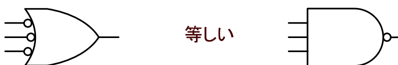
図 3: OR ゲートをド・モルガンの定理を使って変換
